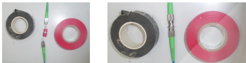
图 5.11.4-1 光纤端头和光纤耦合器图光纤连接
