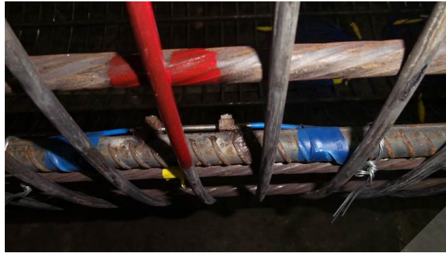
图 5.3-2 管桩内部光纤光栅传感器
