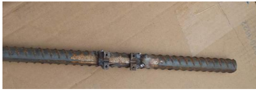
图 5.4-2 桩基植入光纤光栅传感器底座
