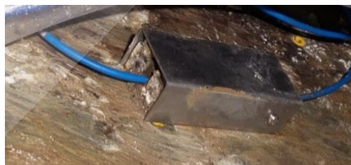
图 5.12-2 混凝土表面传感器保护 I
