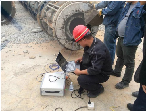
图 5.7-2 管桩预制后单点测试
